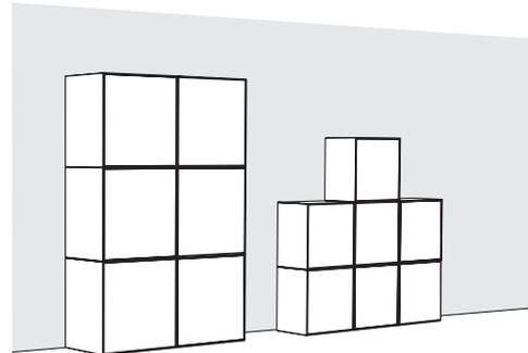
Bei now! easy besteht die Möglichkeit, Baukästen zu stapeln. In diesem Fall ist für jeden gestapelten Baukasten ein Hängebeschluss zu bestellen.
